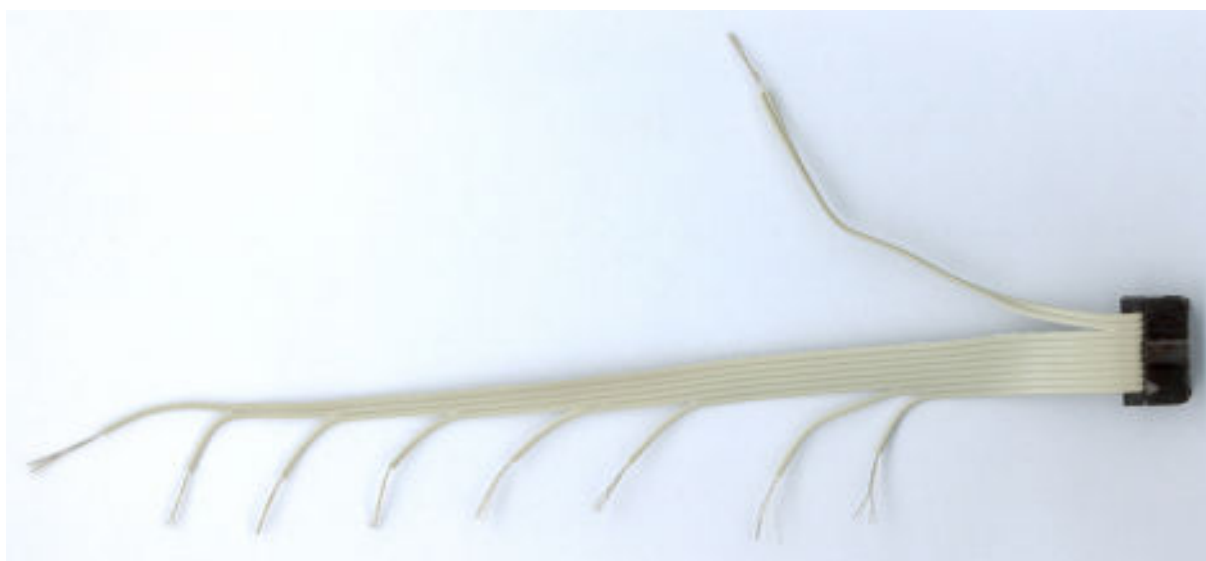
Fils dénudés à l'extrémité
