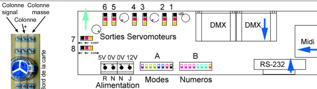
ATTENTION au sens de branchement des servomoteurs, brancher un servo à l'envers est **destructif**.
